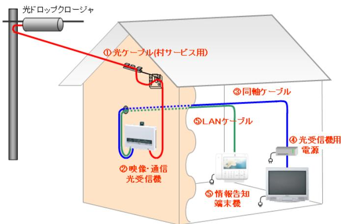
放送サービス・通信サービスの両方に加入された場合の工事概要図(例)
