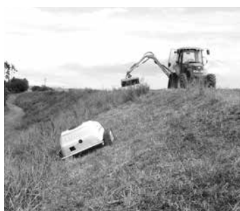
リモコン式自走草刈機による畦畔の除草作業 (総建視察研修)
